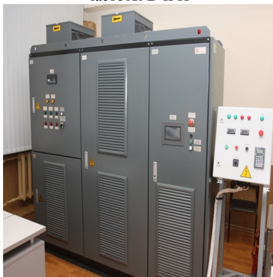
Комплексный учебный стенд с физической моделью высоковольтного преобразователя частоты ВЧРП
