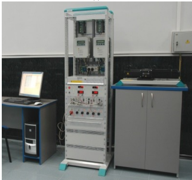
Комплексный учебный стенд с физической моделью высоковольтного преобразователя частоты ВЧРП
